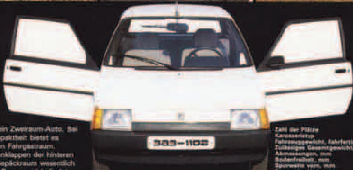
**TAVRIA** — ein Zweiraum-Auto. Bei äußerlicher Kompaktheit bietet es einen geräumigen Fahrgastraum. Durch Zusammenklappen der hinteren Sitze wird der Gepäckraum wesentlich vergrößert. Das Reserverad befindet sich unter der Motorhaube.
